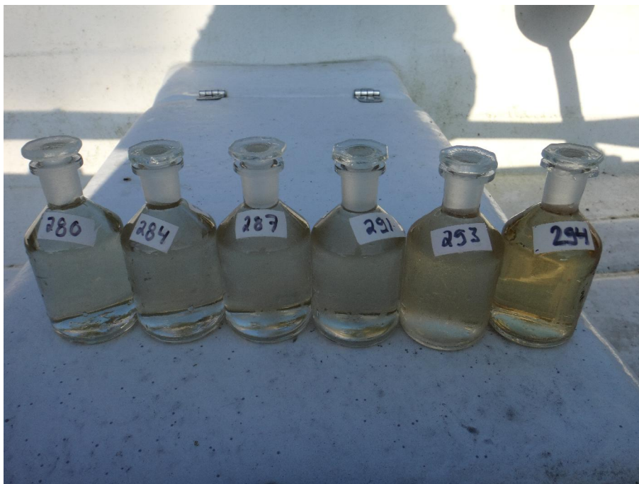
Järvien happinäytteet otetaan kirkkaisiin hioskorkillisiin lasipulloihin. Kuva: LUVY/Arto Muttilainen
